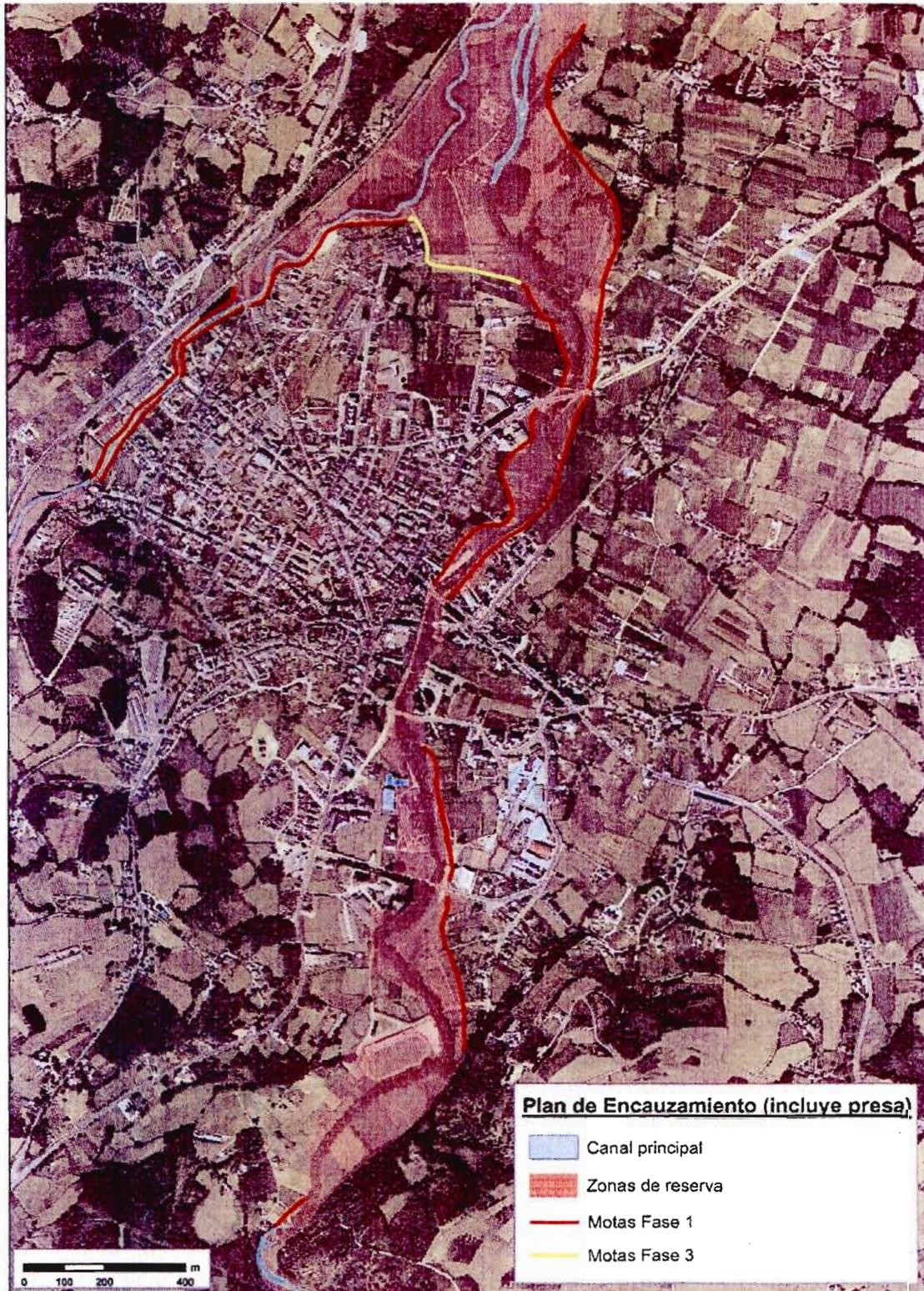
Figura 3. La presa de laminación de avenidas y el plan de encauzamiento en los ríos Sarria y Celeiro concentrarían la peligrosidad en los terrenos encerrados entre motas, que representan los espacios de reserva.
